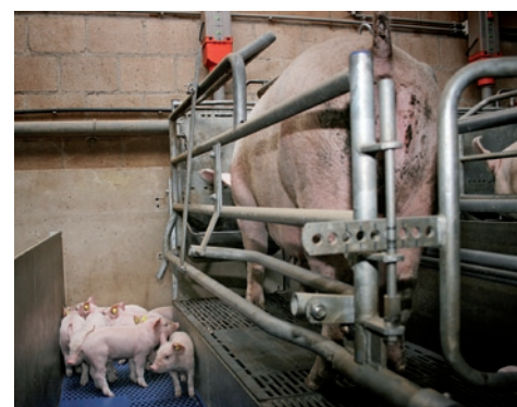
De hele box gaat omhoog, inclusief voerbak. De voeddosator hangt daarom hoger en de valpijp is telescopisch gemaakt.
